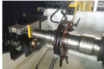
(b) Utilizzo del magnetoscopio mediante bobina
