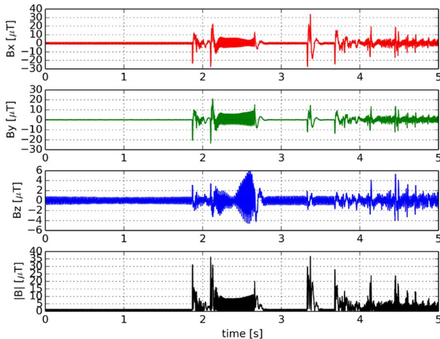
Figura 16 forme d'onda delle componenti cartesiane e del modulo dell'induzione magnetica.
