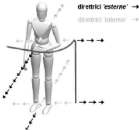
Figura 29 Direttrici per il calcolo delle distanze di rispetto).
