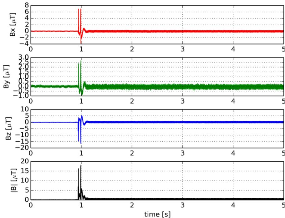
Figura 28 forme d'onda delle componenti cartesiane e del modulo dell'induzione magnetica.
