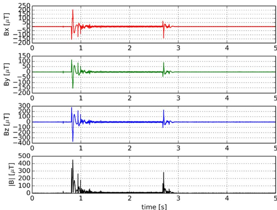
Figura 4 forme d'onda delle componenti cartesiane e del modulo dell'induzione magnetica.
