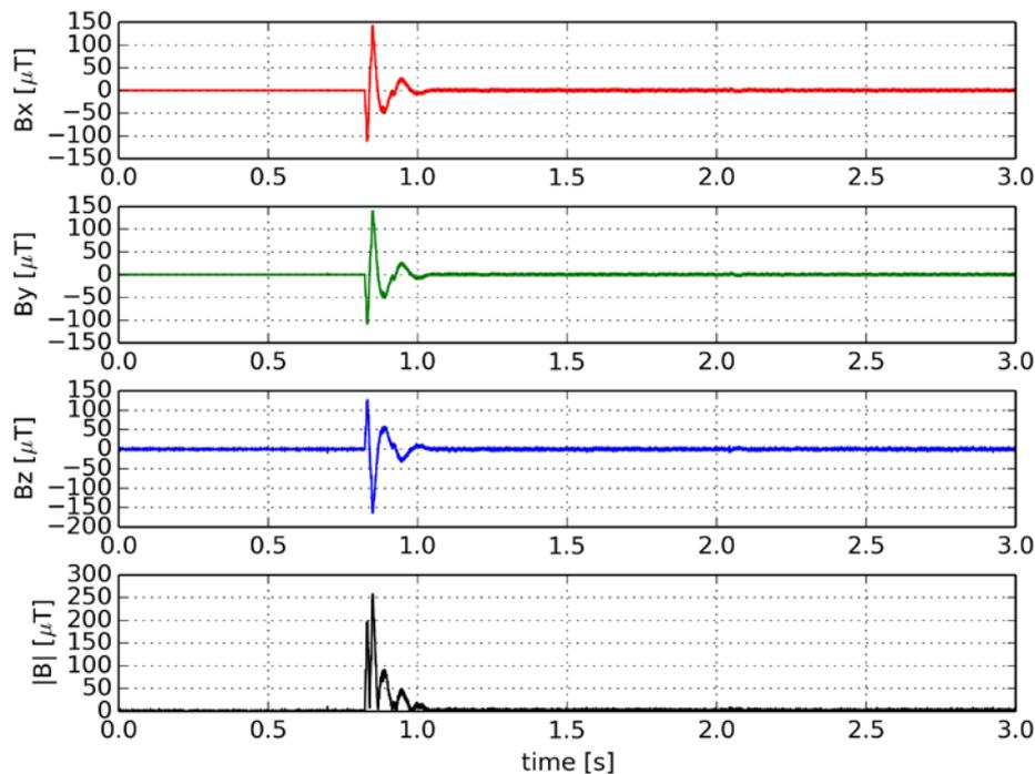
Figura 7 forme d'onda delle componenti cartesiane e del modulo dell'induzione magnetica.
