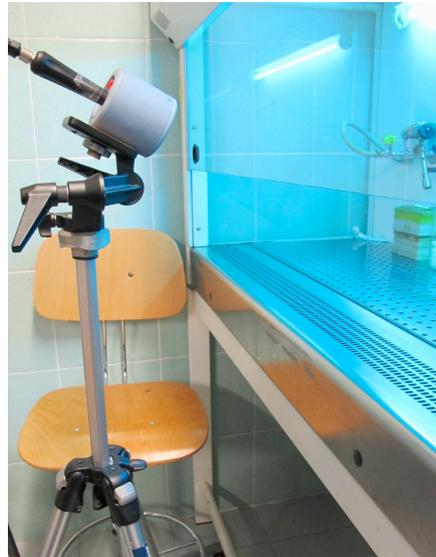
*Figura 1: Cappa germicida, Esempio Misura con vetro aperto: distanza 20cm*
