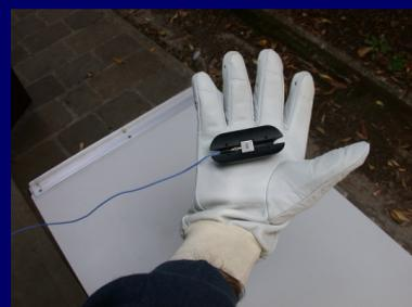
Le prove di certificazione vanno effettuate in laboratorio con uno shaker elettrodinamico dotato di una maniglia in grado di misurare la forza di prensione e di spinta. Le prove per la rilevazione delle trasmissibilità  $TR_M$  e  $TR_H$  vanno eseguite con due spettri di eccitazione M ed H.
