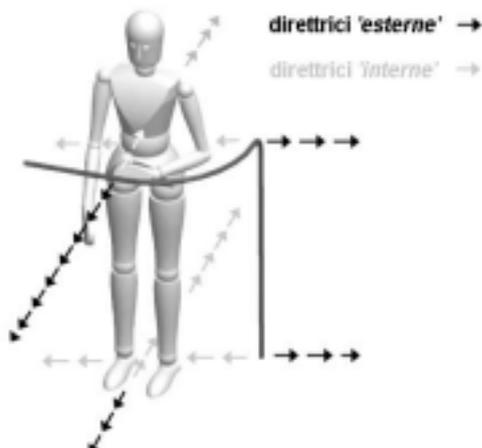
Figura 2 Diretrici per il calcolo delle distanze di rispetto).
