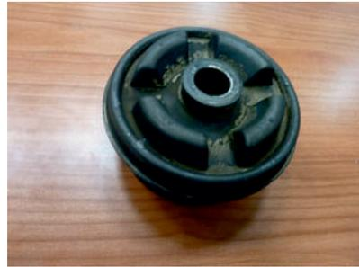
Silent block assiale in gomma montato sotto la cabina sul lato anteriore (trattori n. 1, 2, 4) e sul lato posteriore (trattori n. 1, 2). A destra particolare dell'elemento in gomma dei silent block assiali
