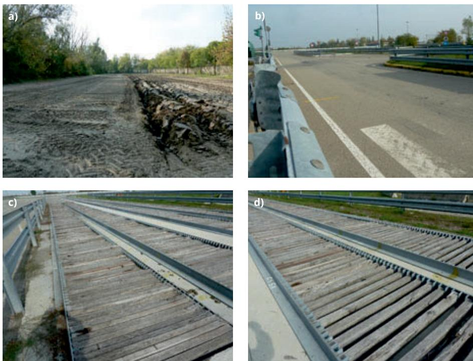
Superfici di prova presso il costruttore: a) terreno; b) strada asfaltata; c) pista a risalti rougher track; d) pista a risalti smoother track
