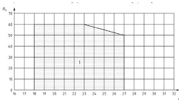
Figura 2- Criterio accettabilità umidità relativa in funzione della temperatura (Classe A). L'area sotto la curva indicata con il numero 1 rappresenta l'area di accettabilità dei valori di umidità relativa in funzione della temperatura in cabina. misure in posizione operatore secondo protocollo specificato dalla norma norma UNI EN 14813-2
