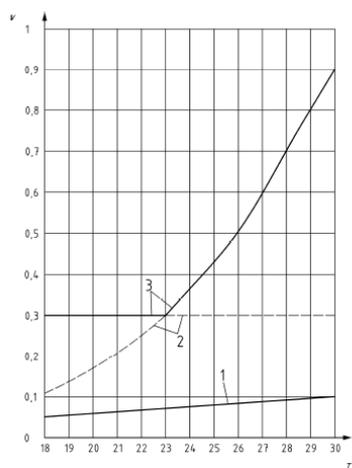
Figura 1 – Intervalli accettabilità velocità dell'aria in funzione della temperatura per le categorie A-B (misure in posizione operatore secondo protocollo specificato dalla norma norma UNI EN 14813-2
