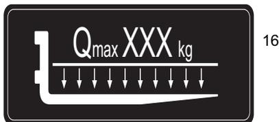
Il diagramma di carico (16) indica la portata massima Q (in kg) dell'organo di presa del carico con carico distribuito uniformemente.
