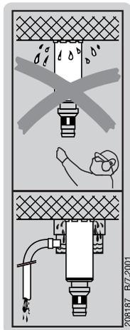
Per i lavori sui soffitti è necessario utilizzare il sistema di raccolta acqua in combinazione con un aspiratore per liquidi.
