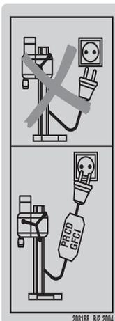
Per gli attrezzi senza PRCD è necessario utilizzare un trasformatore di separazione.
