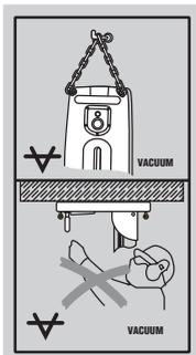
Sopra: Per i lavori di foratura in orizzontale con fissaggio a vuoto non è consentito utilizzare il supporto a colonna senza un fissaggio supplementare.
