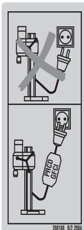
Lavorare solamente con un PRCD correttamente funzionante.
